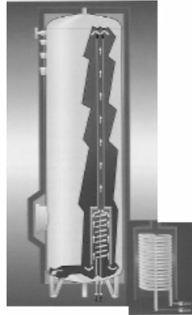
**Figure 4.10 Réservoir d'eau chaude sanitaire avec échangeur de récupération**
