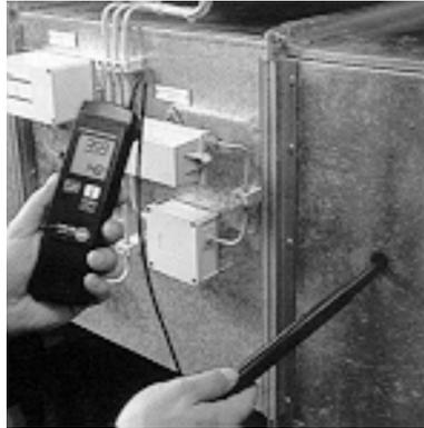
**Figure 3.4** *Mesure du débit dans un conduit*
