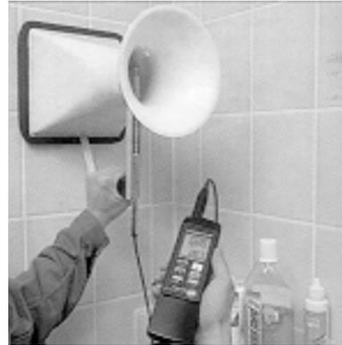
**Figure 3.5** *Mesure du débit à la sortie d'une bouche*
