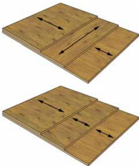
**FIGURE 11** • Orientation du fil des placages d'un contreplaqué (en haut) et d'un LVL (en bas)
