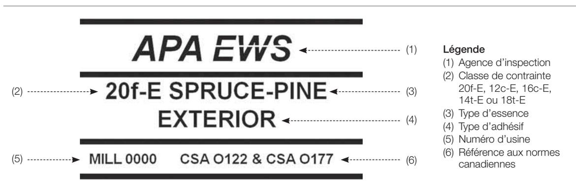
**FIGURE 31** • Identification d'un BCL conforme à la norme CSA O122 (source : APA-EWS)
