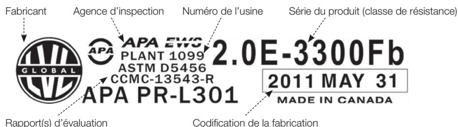
FIGURE 20 • Exemple d'identification d'un bois LVL (source : LVL Global)
