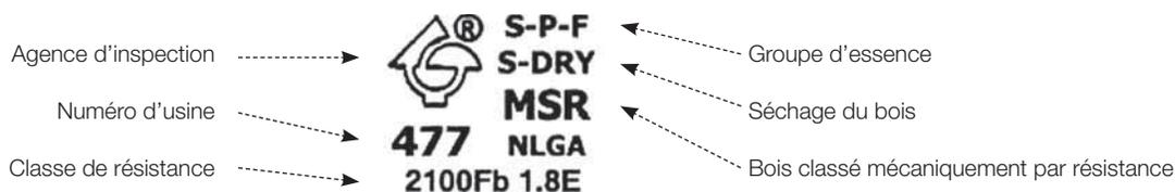
**FIGURE 7** • Estampille de qualité d'un bois classé mécaniquement par résistance (source: CIFQ)
