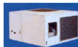
un seul niveau. Un appareil est capable de desservir une surface d'environ 700 m<sup>2</sup>. Il peut être réversible et assure la ventilation et le chauffage par résistances électriques ou par inversion de cycle. Ce type d'appareil est inapproprié au traitement d'une salle de petite surface.
