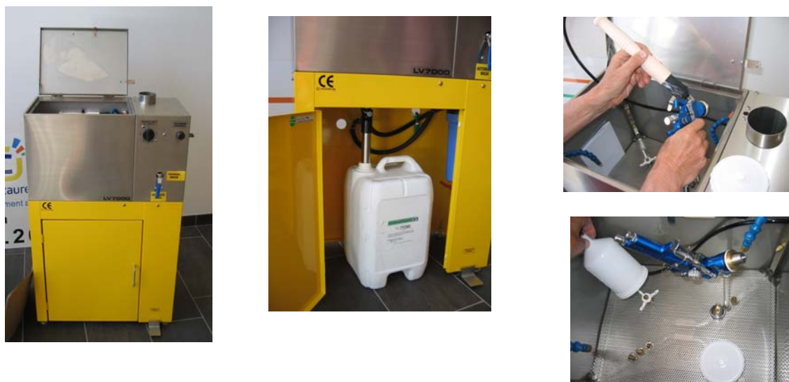
Figure 32 : Nettoyeur de pistolets avec un éco-nettoyant
