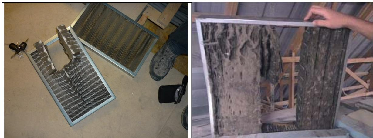
**Figure 2.8 : Filtres tellement encrassés qu'ils se sont désagrégés dans le ventilateur**
