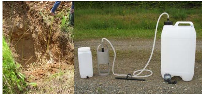
**Exemple de test de perméabilité (PORCHET)**
