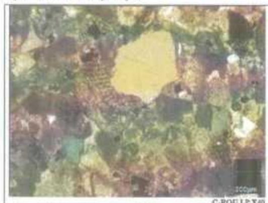
**Pierre de Rouffach** : Calcarénite à pellets, à ciment micritique et à quartz détritique
